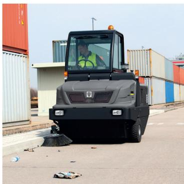
Kabinen und Schutzdächer für erhöhte Sicherheit, zum Beispiel in Regallagern. Wahlweise auch mit Heizung oder Klimaanlage. Licht und Rundumkehrleuchte für erhöhte Sicherheit, bessere Sichtverhältnisse und Arbeiten bei schlechter Witterung, zum Beispiel im Winter.
