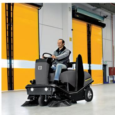
Aufgeschäumte Räder oder Vollgummiräder für Produktionsbereiche mit zum Beispiel Metallspänen oder Glassplittern. Nicht zeichnende Superelastikräder für die Anwendung batteriebetriebener Maschinen auf hellen Oberflächen.
