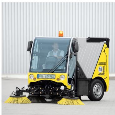
Das Wassenumlaufsystem sorgt für längere Arbeitsintervalle. Das Schmutzwasser aus dem Kehrbehälter wird dabei mehrfach zur Staubbindung im Saugmund eingesetzt. Serienmäßig bei allen ICC 2 in Adv-Ausstattung.
