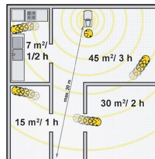
Optimale Positionierung der Ladestation. Maximaler Aktionsradius: 20 m.
