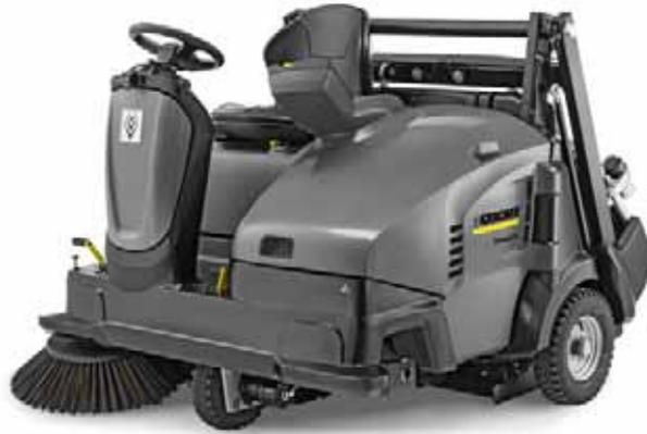
Mit einer Arbeitsbreite von 125 cm eignet sich die Kehrmaschine ideal für hohe Flächenleistungen. Dank hydraulischem Frontantrieb kann sie sich fast auf der Stelle drehen und kehrt kombiniert mit dem einzigartigen Kehrsichelbesen Ecken mühelos aus. Ihre Hauptkehrwalze ist auf der Hinterachse positioniert, was ein Aufsitzen des Kehrsystems beim Überfahren von Hindernissen verhindert. Neu ist auch die vollautomatische und permanente Filterreinigung durch Druckluftimpulse.
