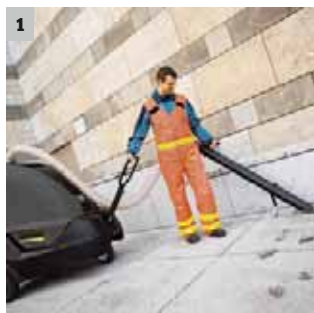
1 1-Hand-Bedienung über Deichsel
